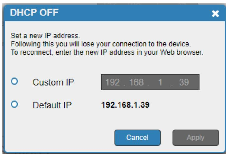
Рис. 23. Закладка Communication (Связь) — Сообщение о выключении режима DHCP
