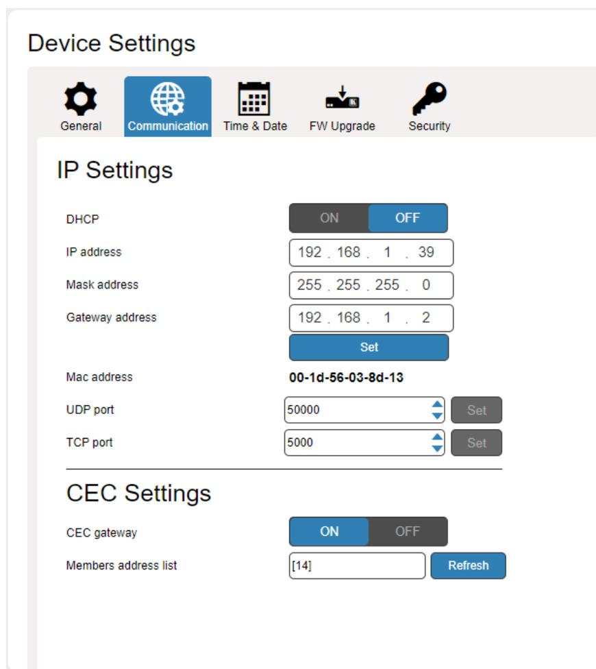
Рис. 22. Страница Device Settings (Настройки устройства) — Закладка Communication (Связь).
